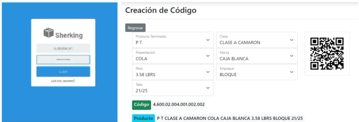
Para la solución 4 de implementar un proceso de codificación QR para mejorar el control de los productos, se muestra en la figura 54 el detalle paso a paso en el software para el registro de productos nuevos a través del escaneo con el código QR.
