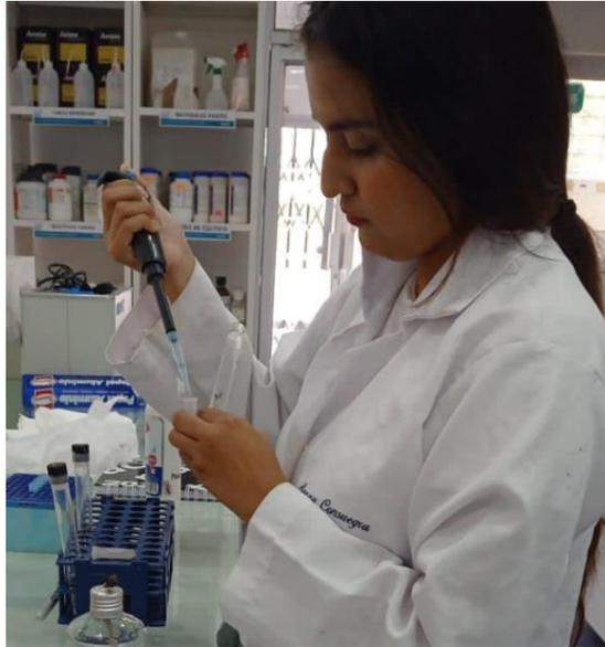
*Nota.* La imagen muestra la preparación del antibiótico que tuvo que ser disuelto con etanol al 99% y luego con solución salina al 2% para que llegue a la concentración deseada.
