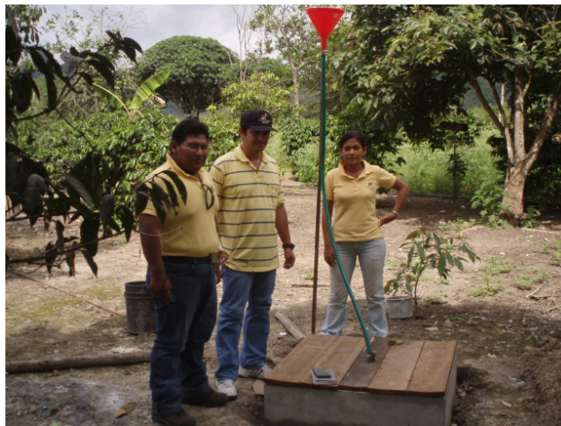
Foto. 4.9.- Colector de Aguas Lluvias.
