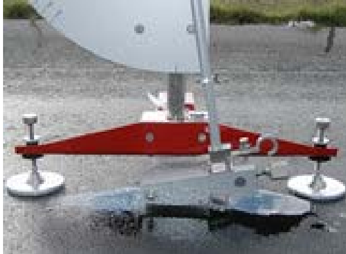
FOTO No. 3.14.- Equipo Grip Tester
