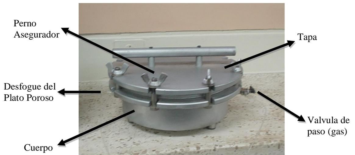
**Fig. 3.4 – Componentes Externos del Plato Poroso**
