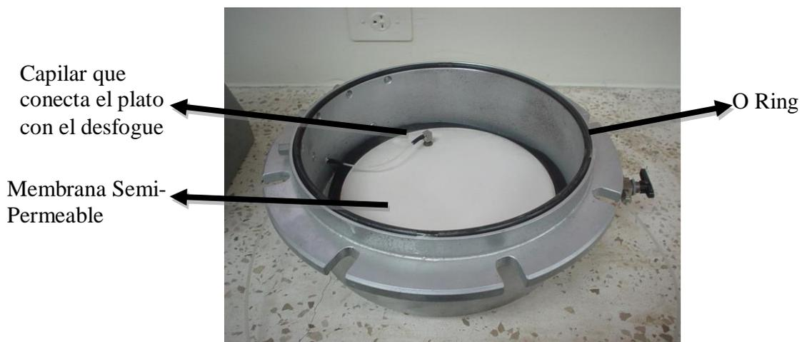
**Fig. 3.5 – Componentes Internos del Plato Poroso**
