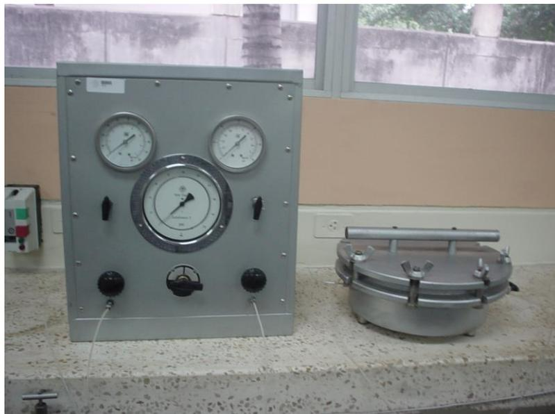
**Fig. 3.1 – Equipo diseñado para Medición de Presión Capilar**
