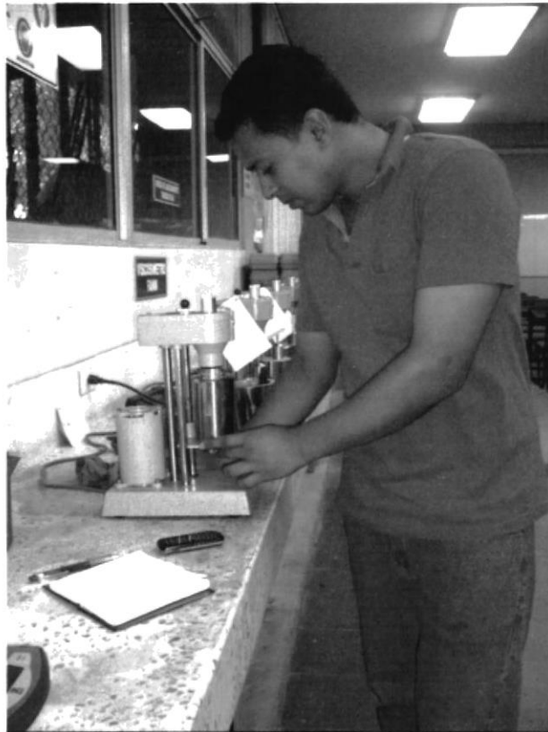
Foto # 6.1 Determinando la viscosidad aparente
