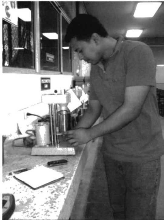
Foto # 4.1 Determinando la viscosidad plástica
