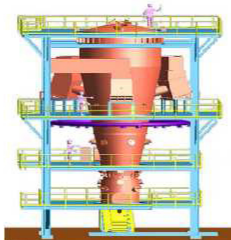
Gráfico20. Gasificador por Plasma modelo G-65. Fuente: Westinghouse Corporation.
