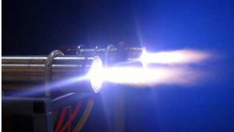
Gráfico10. Antorchas de alto voltaje de ca produciendo Plasma a más 6.000°C. Fuente: Google
