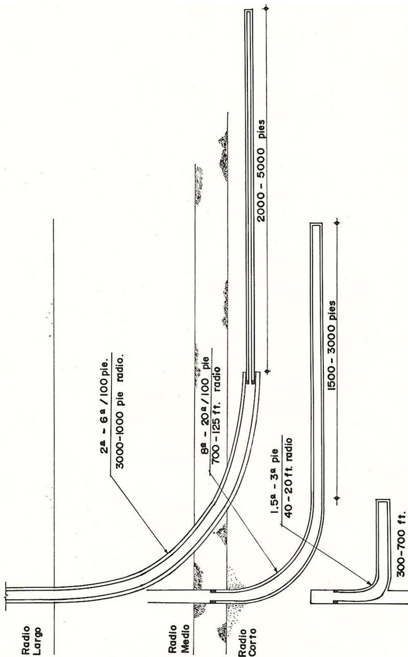
FIG. N<sup>o</sup> 2. TIPOS DE POZOS HORIZONTALES. (PETROLEUM 1990)
