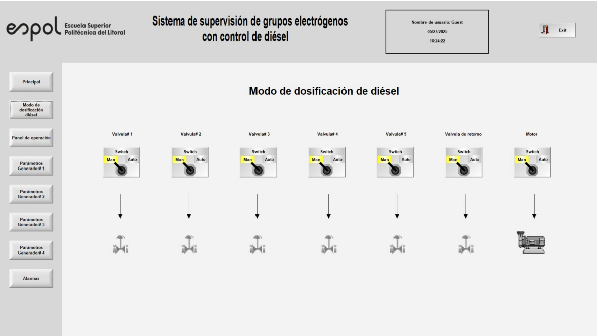
Ilustración 3.8 SCADA- Modo de operación
