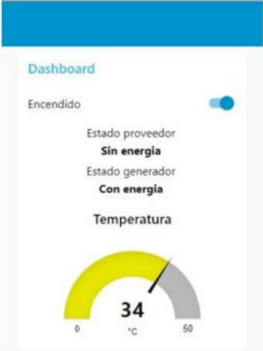
Ilustración 1.6 Monitoreo de generador a través de IoT [20]
