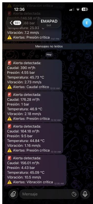
Figura 3.5 Envío de datos de NodeRed a Telegram
