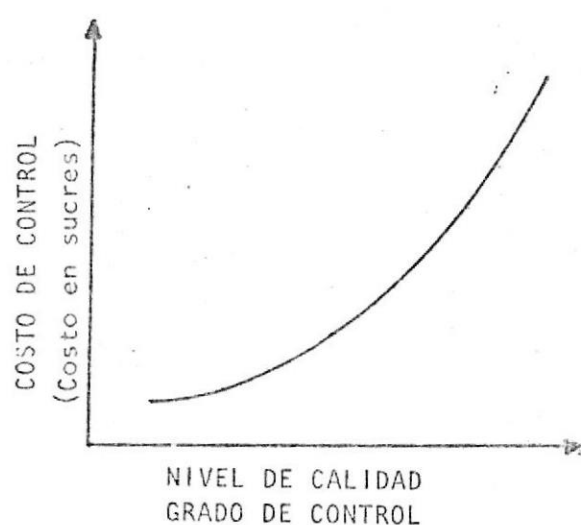
DIAGRAMA 8-1. Relación entre costo de control y nivel de calidad o grado de control
