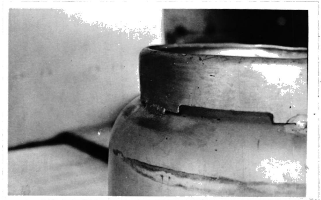
UNION SOLDADA MEDIANTE PROCESO TIG
