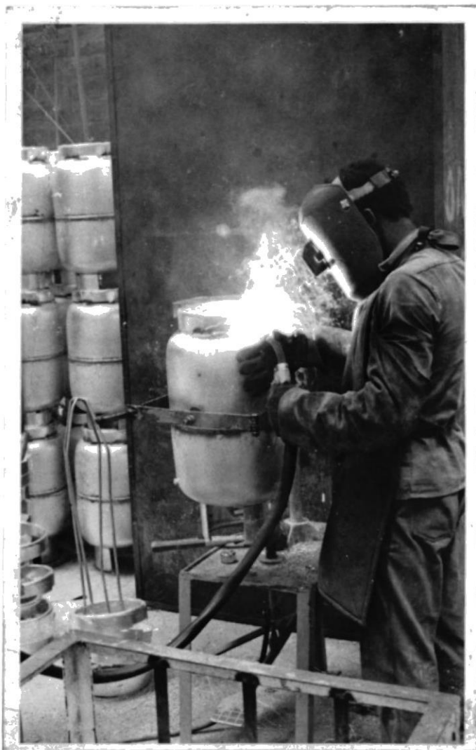
OPERARIO EJECUTANDO EL PROCESO MIG EN PLANTA
