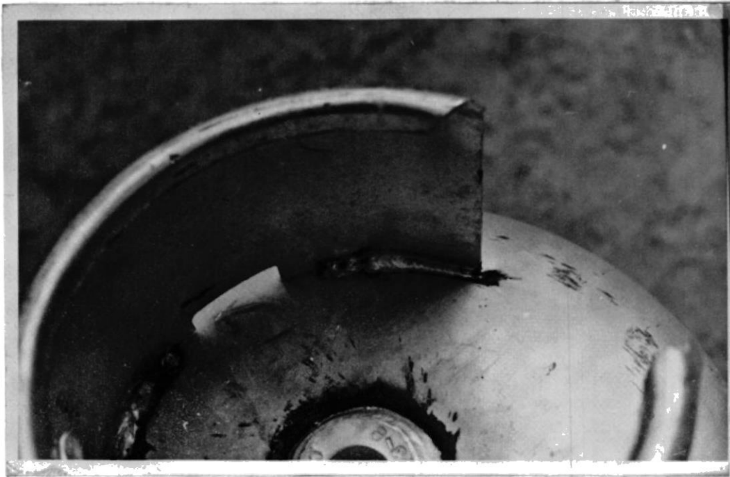
DEFECTOS DE SOLDADURA (PROCESO MIG) Figura N° 6
