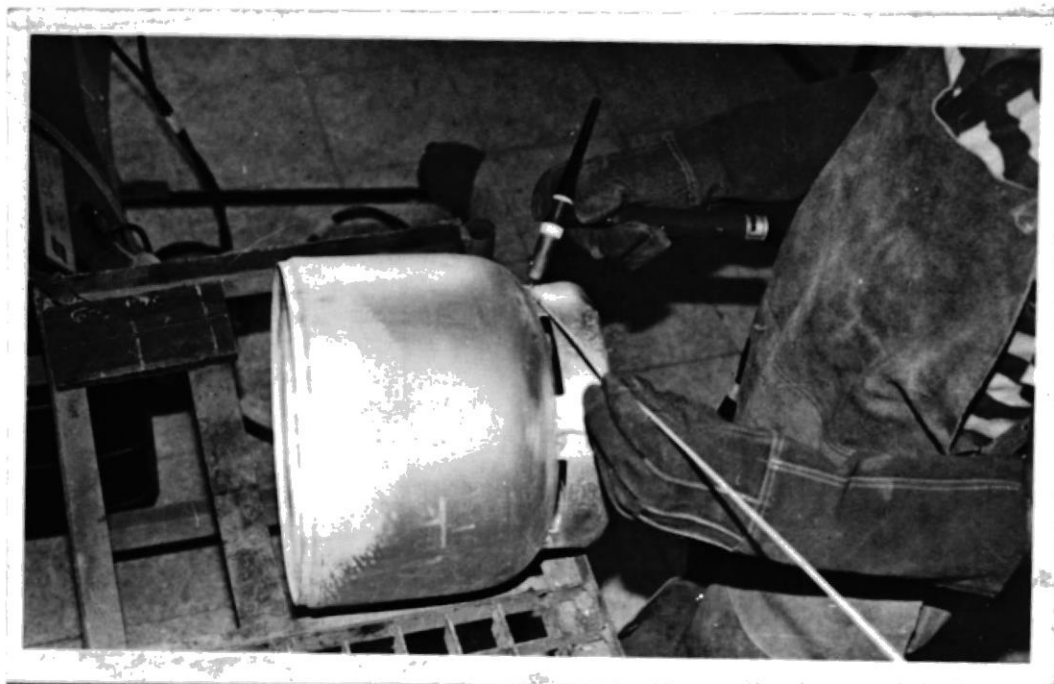
EJECUCION DEL PROCESO TIG
