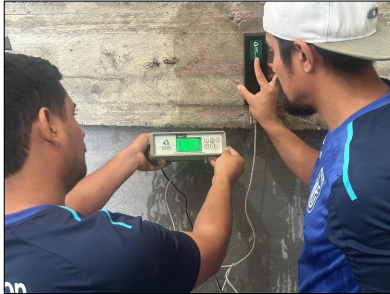
Ilustración 7. Resistividad eléctrica en elementos de hormigón armado.
