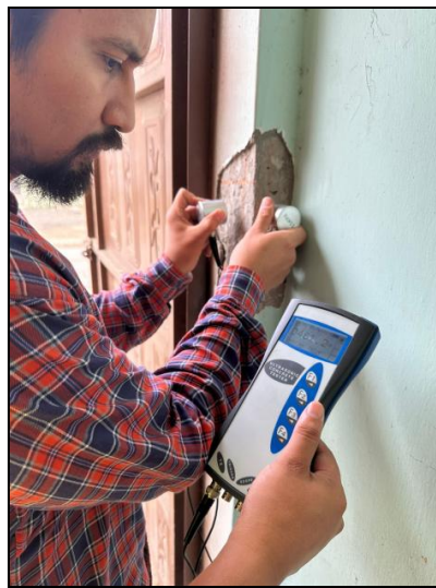
Ilustración 8. Pulso ultrasónico (UPV) en elementos de hormigón armado.
