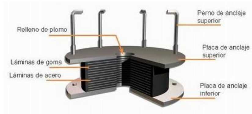
Figura 2.2 Aislador LRB y sus componentes (Grupo Grasa, 2020)
