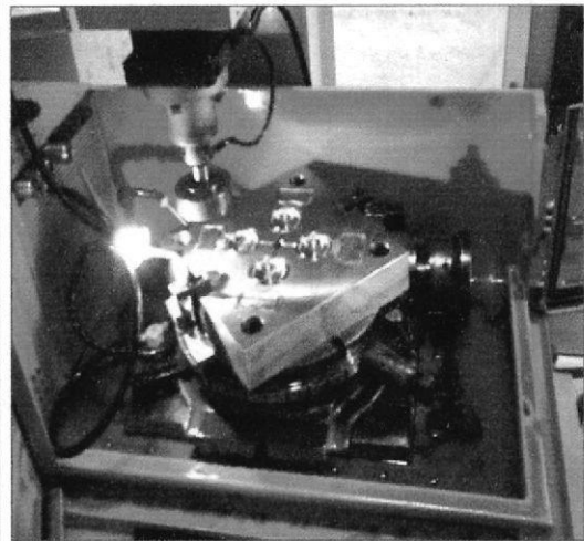
Fig.# 27. Elaboración de la placa porta cavidades.
