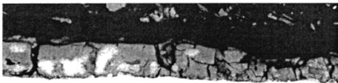
Micrografia n o 10: corpo-de-prova revestido com Galvalume ® exposto durante 42 meses em La Voz (Venezuela). Pode-se verificar intensa corrosão do revestimento determinando desprendimento de dendritas ricas em alumínio. Notar que o substrato ainda não apresentou corrosão severa: nesta estação ocorre proteção catódica devido à alta salinidade. Sem ataque. x750.
