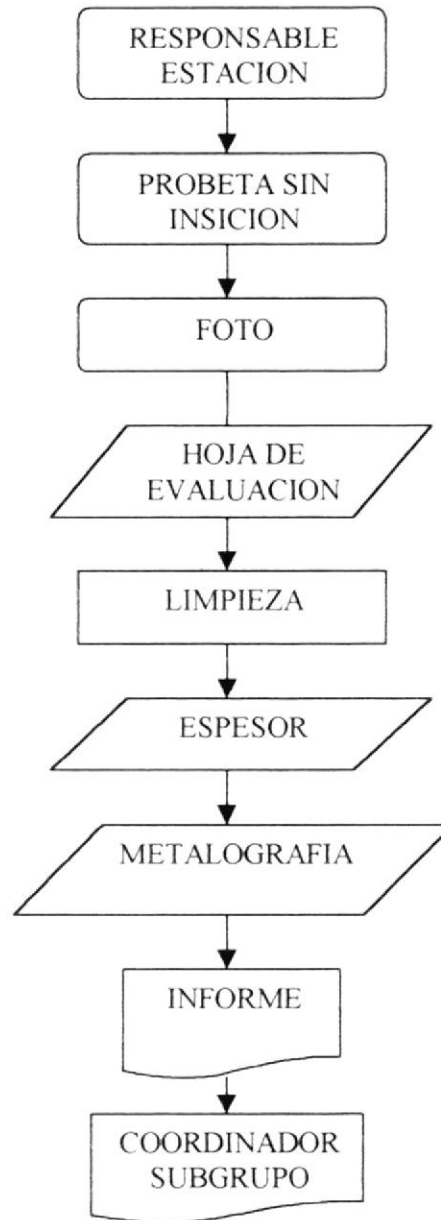
FIGURA 1.3. RUTA CRITICA- PROBETAS DE METALIZADO SIN INCISION
