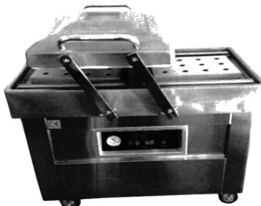
Imagen 3.6: Selladora al Vacío con Doble Cámara
