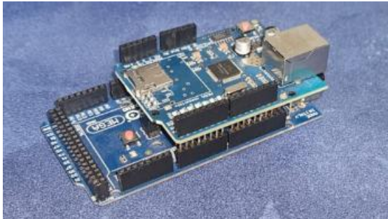
Figura 3.32 Apilamiento de la Shield Ethernet
