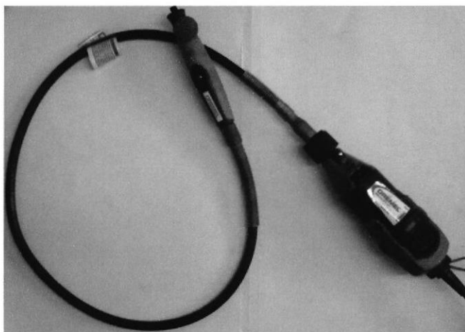
Figura 19.- Acoplamiento entre el DREMEL MULTIPRO y el Eje Flexible
