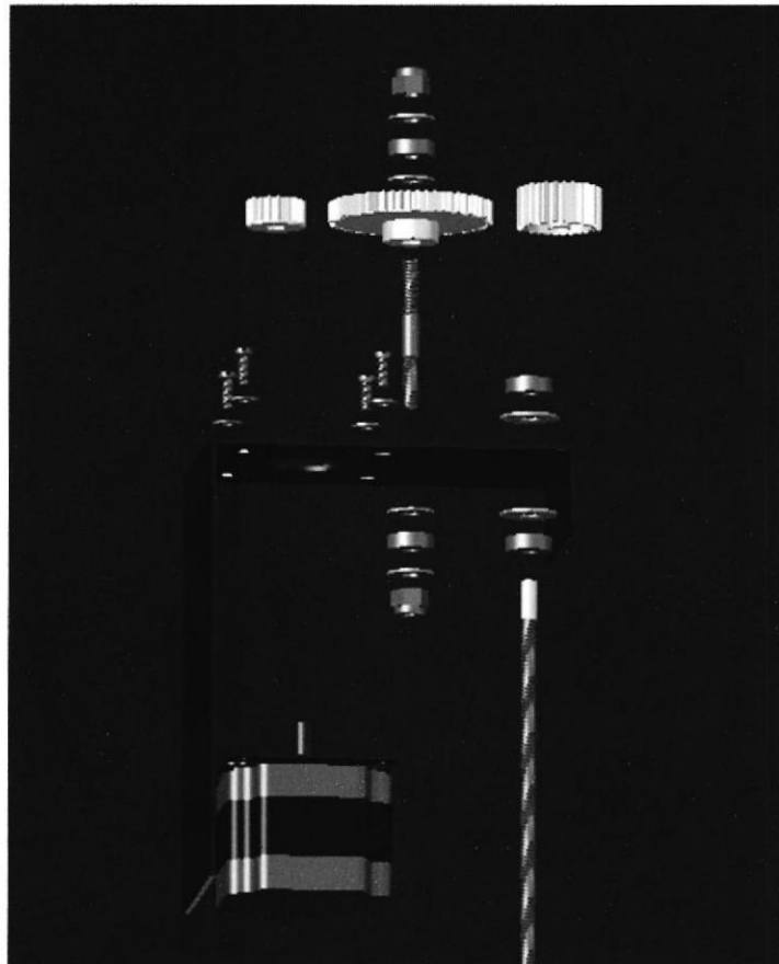
Figura 22.- Vista superior de la pieza que sujeta al motor del eje Z con su juego de engranes y piezas de sujeción.
