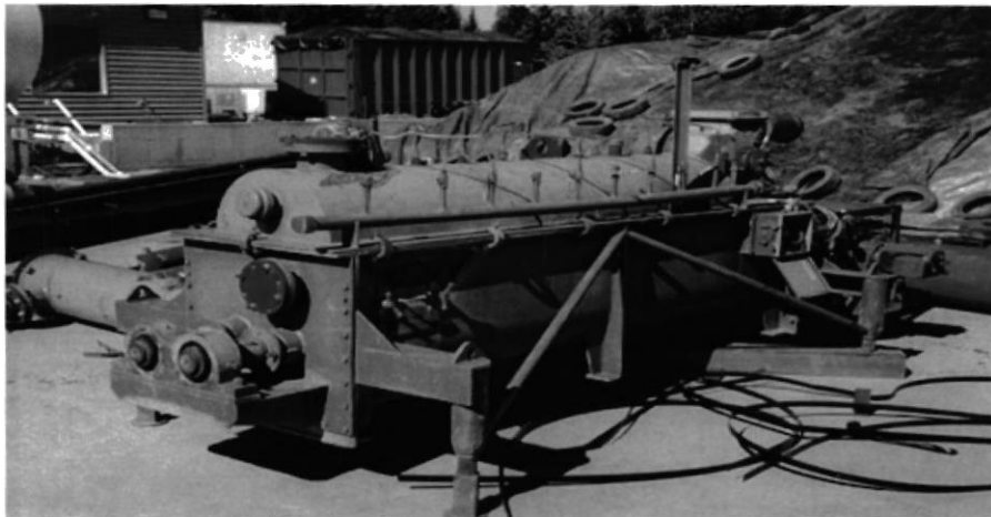
CÁMARA DE ENFRIAMIENTO
