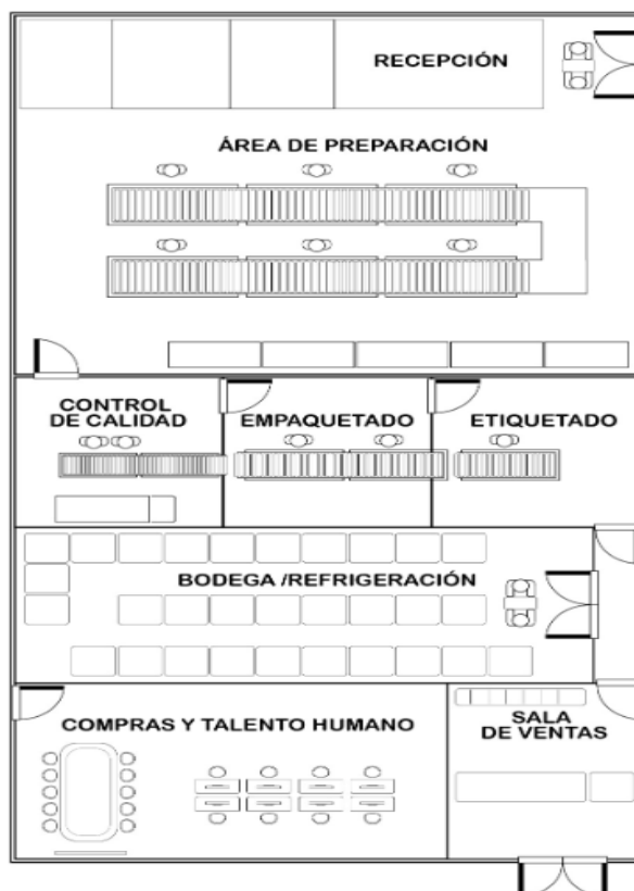
Figura 12: Distribución de la Planta
