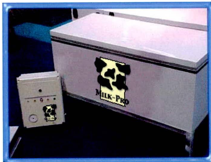
Pasteurizador Milk Pro, con caja de control remoto
