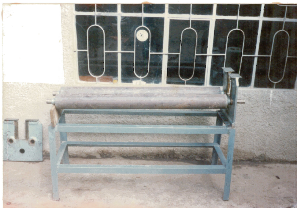
Figura # 20. Montaje de placa lateral izquierda sobre la mesa mediante sujetadores roscados.
