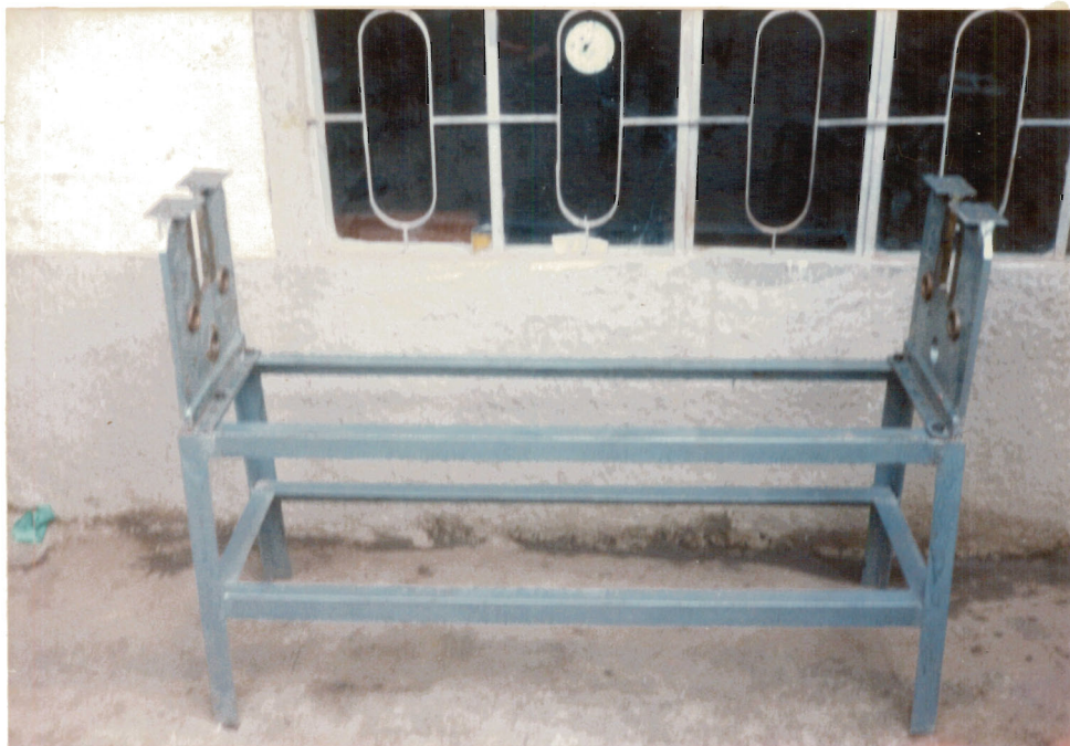
Figura # 20. Montaje de placa lateral izquierda sobre la mesa mediante sujetadores roscados.
