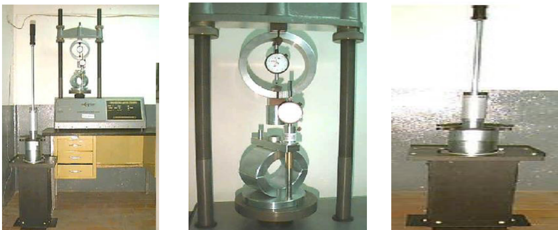
Figura 2.8 Aparato Marshall para medir estabilidad vs. porcentaje de asfalto residual
