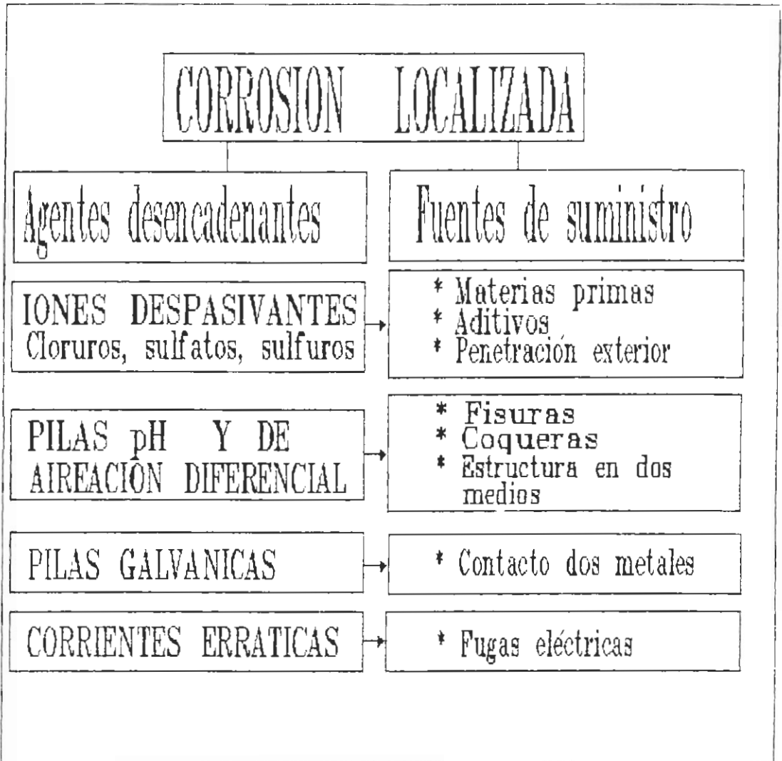
Figura Nº 11. Factores que provocan corrosión localizada.
