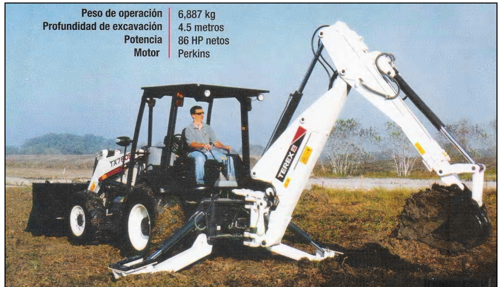
Figura 3.1 Retroexcavadora y sus especificaciones
