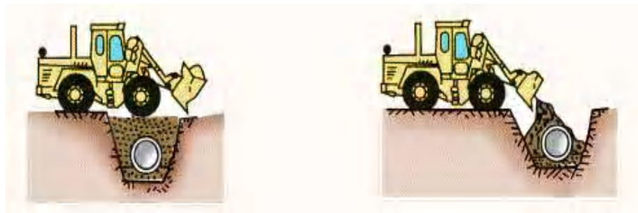
a) No permitir el paso de Maquinaria Pesada
