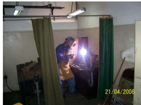
Figura. 3.4 Fotografía del operador soldando en posición 3G.
