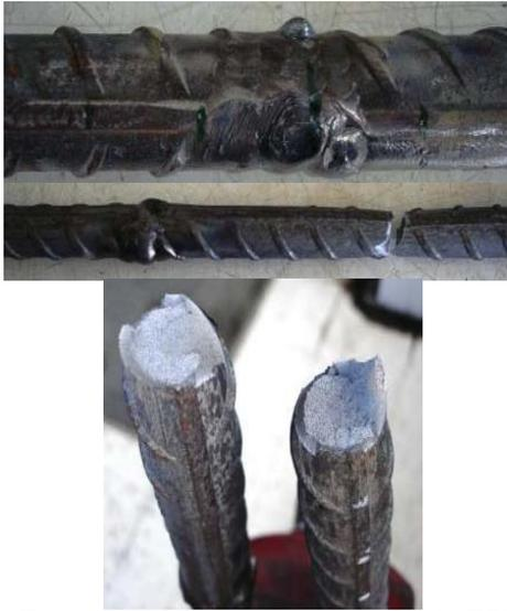
Figura. 3.10 Probeta 2, con electrodo E7018.
