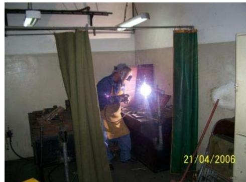
Figura. 3.4 Fotografía del operador soldando en posición 3G.
