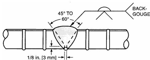
Fig. 2.2 Unión directa a tope, biselada en ambos extremos.
