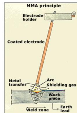
Figura. 2.1 Proceso de Soldadura de Electrodo Cubierto
