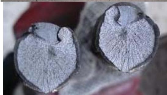
Figura. 3.9 Probeta 1, con electrodo E9018.
