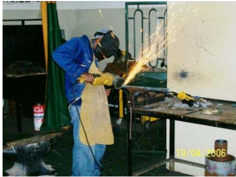
Figura. 3.1 Corte del extremo de la barra de acero con disco de sierra.
