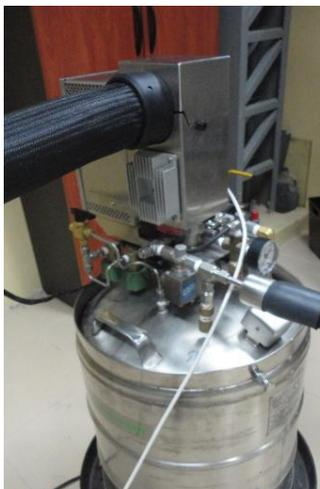
**NOTA:** La posición del cabezal que contiene las dos tuberías por donde pasa el nitrógeno debe estar colocada en la posición adecuada, tal como se muestra en la figura anterior, ya que esto permitirá su correcto funcionamiento.
