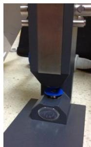
6. Sellar el pan mediante el movimiento del brazo del Sample Press, y luego estará listo el pan con la muestra para realizar la respectiva corrida.
