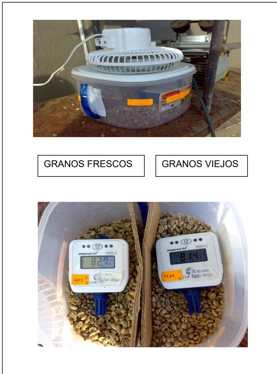
**FIGURA 3.6 PRUEBA DE SUMINISTRO DE AIRE CON SENSORES DE HUMEDAD Y TEMPERATURA**
