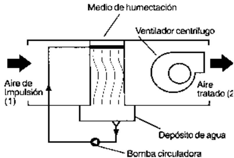
**FIGURA 3.7 DETALLE ESQUEMÁTICO DE UN SISTEMA EVAPORATIVO**
