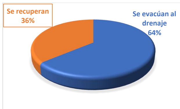
Figura 18. Recuperación de condensado de las purgas de los distribuidores de vapor
