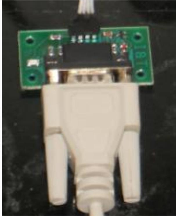
**Figura 3.4 Tarjeta de Transmisión USART**
