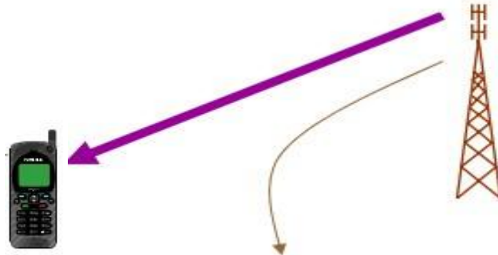
Figura: 3.5. Control de Potencia Lazo Abierto
