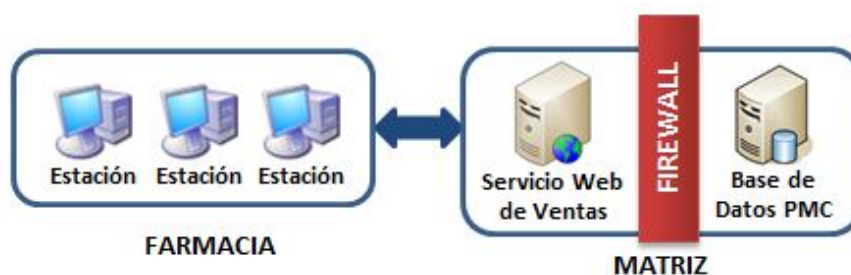
Figura 2.2 Arquitectura del Servicio Web de Ventas
