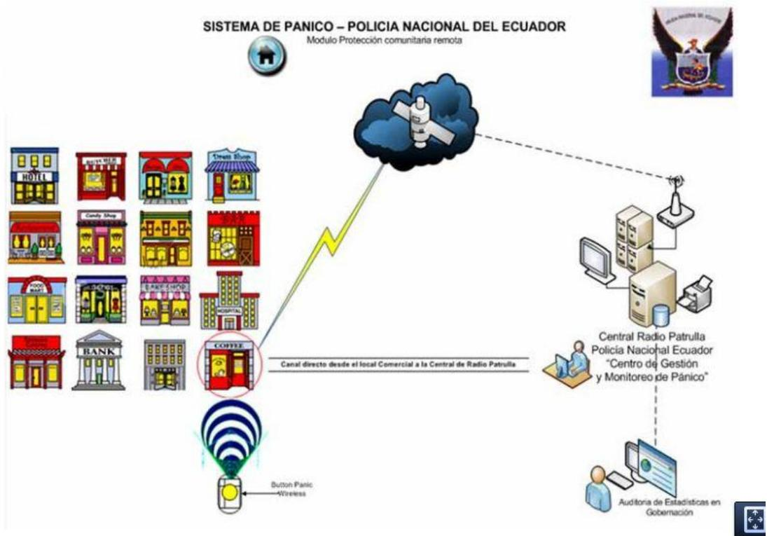
Figura 1.2 Esquema de funcionamiento del sistema Botón de Seguridad para negocios y domicilios [18]
