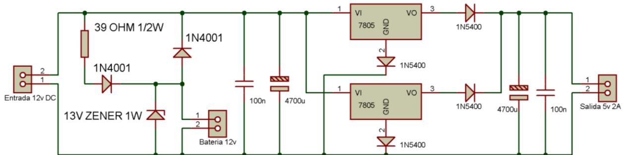
Figura 3.7 Diagrama del circuito de respaldo de energía.
