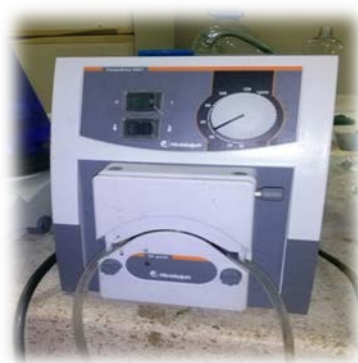
Figura 3.15. Bomba peristáltica utilizada en las pruebas a escala piloto.
