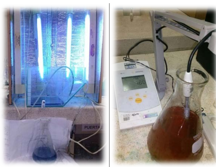
Figura 3.19. Obtención del Agua tratada y neutralización del pH.
