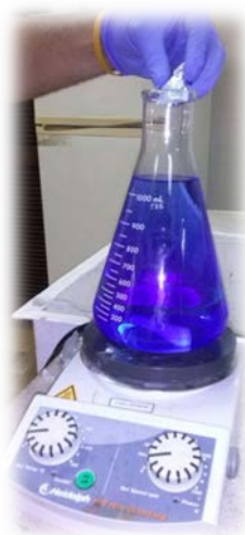
Figura 3.16. Introducción de la dosis de Fe (II) utilizando de un agitador magnético.
