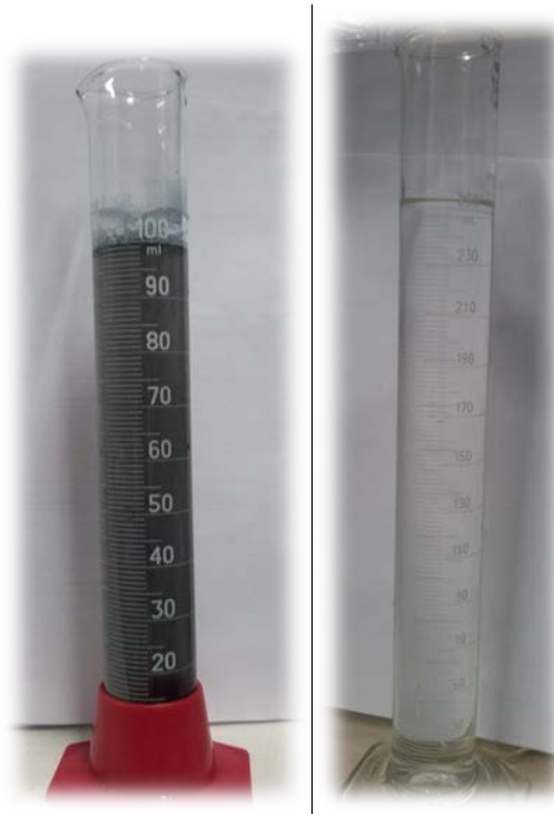
Figura 4.12. Apariencia del efluente sin tratar y al agua tratada de la industria textil aplicando el proceso de foto-Fenton.
