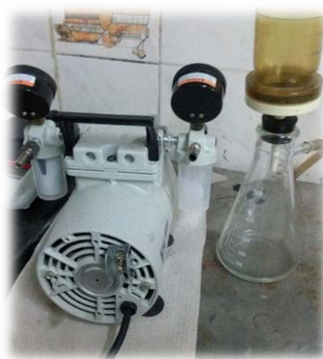
FIGURA 3.5. Filtración al vacío del efluente.
