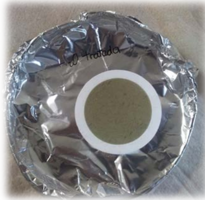
Figura 4.13. Aspecto de los sólidos en suspensión presente en el agua tratada de la industria textil.
