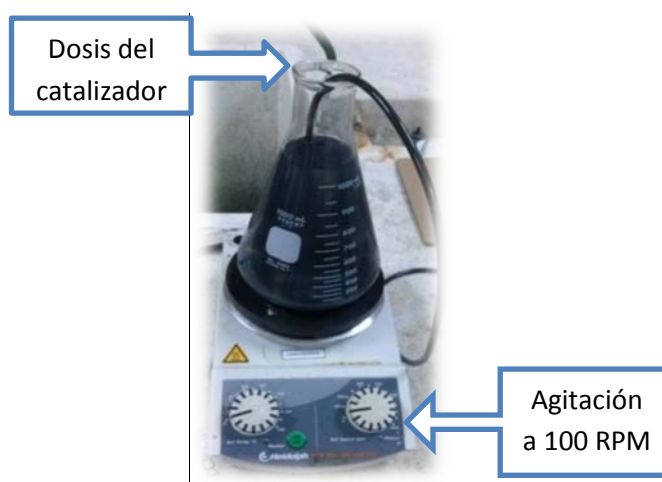
Figura 4.8. Aplicación del catalizador Fe(II) a la muestra de agua de la industria textil.
