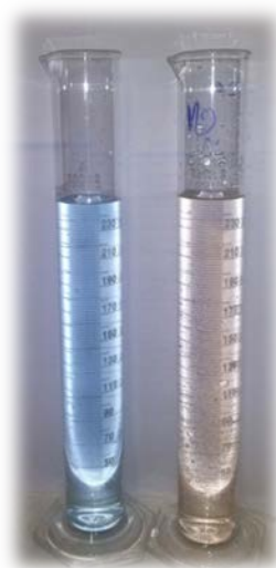
Figura 4.6. Apariencia del efluente y al agua tratada por el proceso de foto-Fenton.
