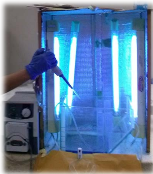
Figura 4.9. Aplicación del proceso de foto-Fenton al efluente de la industria textil a escala piloto.
