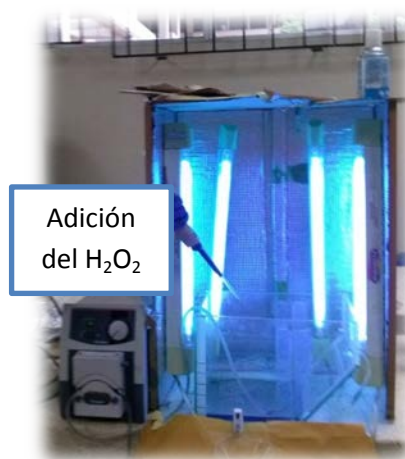
Figura 3.17. Adición de la dosis de H_2O_2 con micro pipeta.
