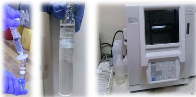
Figura 3.12. Lectura del COT del efluente en el Equipo SHIMADZU TOC-V CSN
