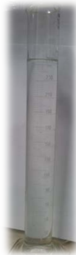
Figura 4.14. Aspecto del agua tratada de la industria textil con el proceso de foto-Fenton.
