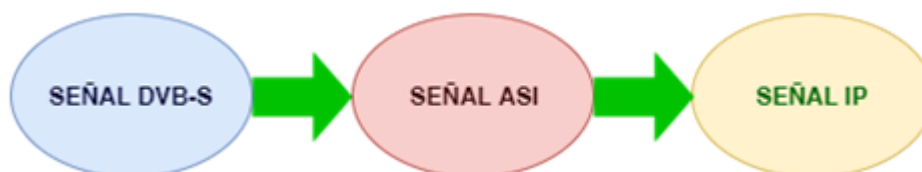
Figura 2.8: Flujo de conversión de la señal DVBS
