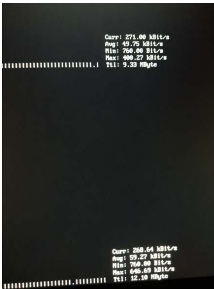
Figura 5.30 Monitoreo de tráfico entrante y saliente durante ataque SYN
