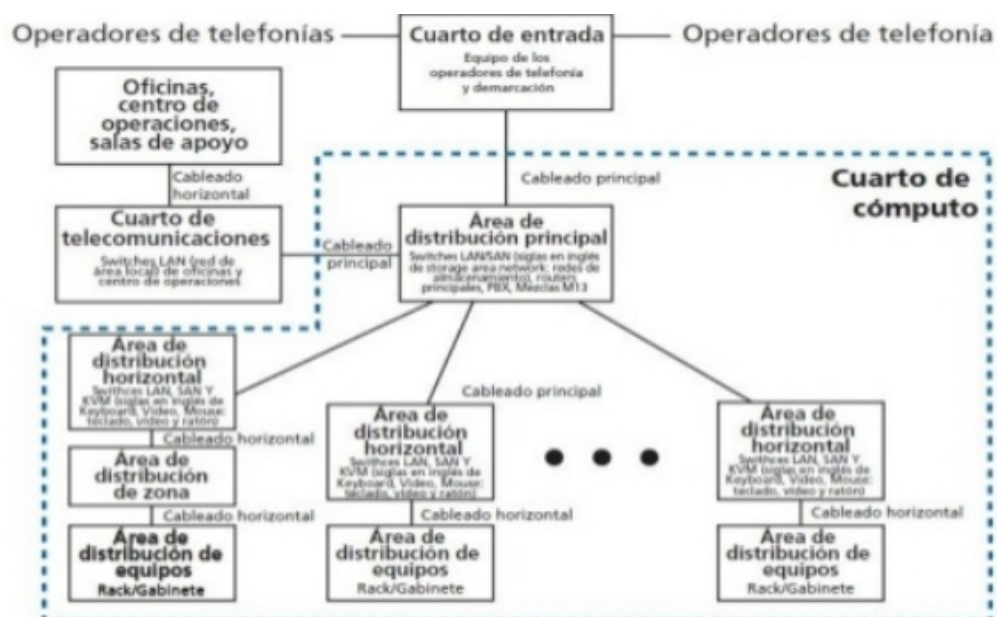
Figura 2.22 Centro de datos que cumple con la Norma TIA-942. Fuente: TIA-942
